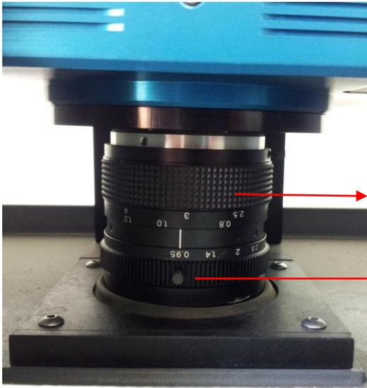
对焦旋钮，调节旋钮，聚焦图像，直到实时图像窗口的图像清晰
